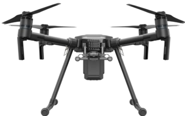
Abbildung 7: Matrice 200 Drohne mit Kamera zenmuse x4s
